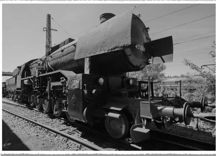
Zumeist Vorkriegsfahrzeuge in reichlich schäbigem Zustand. Bei dem in diesem Bogen vorhandenen Modellen kommt das bildhaft zum Ausdruck. Zuglok ist eine schwere Güterzuglokomotive der Baureihe 42, eine als Kriegslok projektierte Bauart, die ab 1942 in großer Stückzahl produziert wurde. Die Güterwagen sind alle Vorkriegsbauarten, mitunter noch von den Länderbahnen, zum Beispiel den Königlich Preußischen Eisenbahndirektionen, beschafft.
